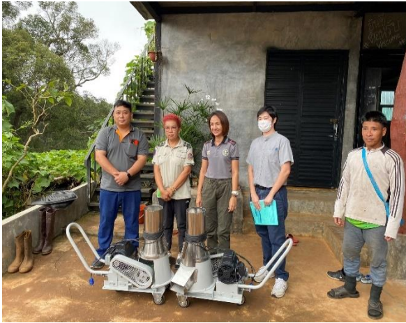
การจัดหาเครื่องกะเทาะเมล็ดแมคคาเดเมีย ขนาด ๕ ลิตร ๖ ใบมีด พร้อมมอเตอร์
